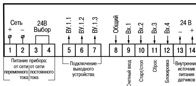
Рисунок 5.1 – Назначение контактов клеммника
