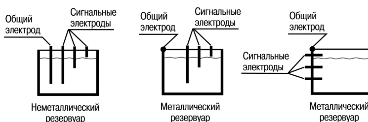
Рисунок 5.4 – Примеры установки кондуктометрических зондов
