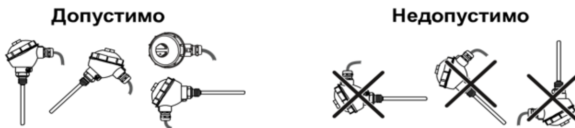
Рисунок 6.1 – Положения датчика при монтаже
