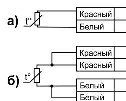
Рисунок В.2 – Схема подключения КДТС с коммутационной головкой: а) двухпроводная схема, б) четырехпроводная схема
