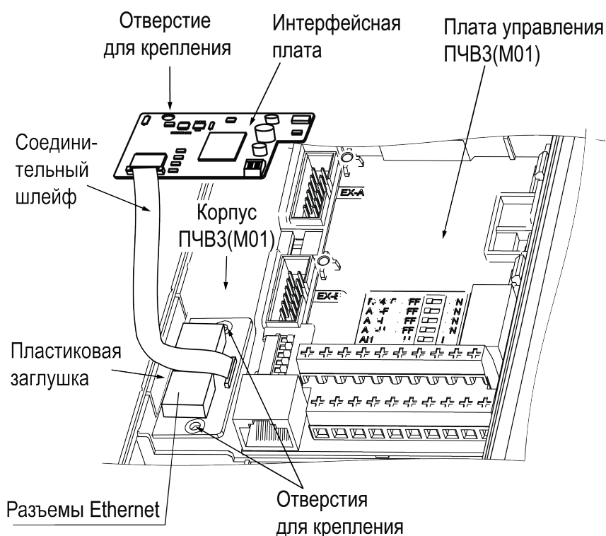
Рисунок 7.27 – Монтаж платы на преобразователях частоты мощностью 5,5 – 45 кВт
