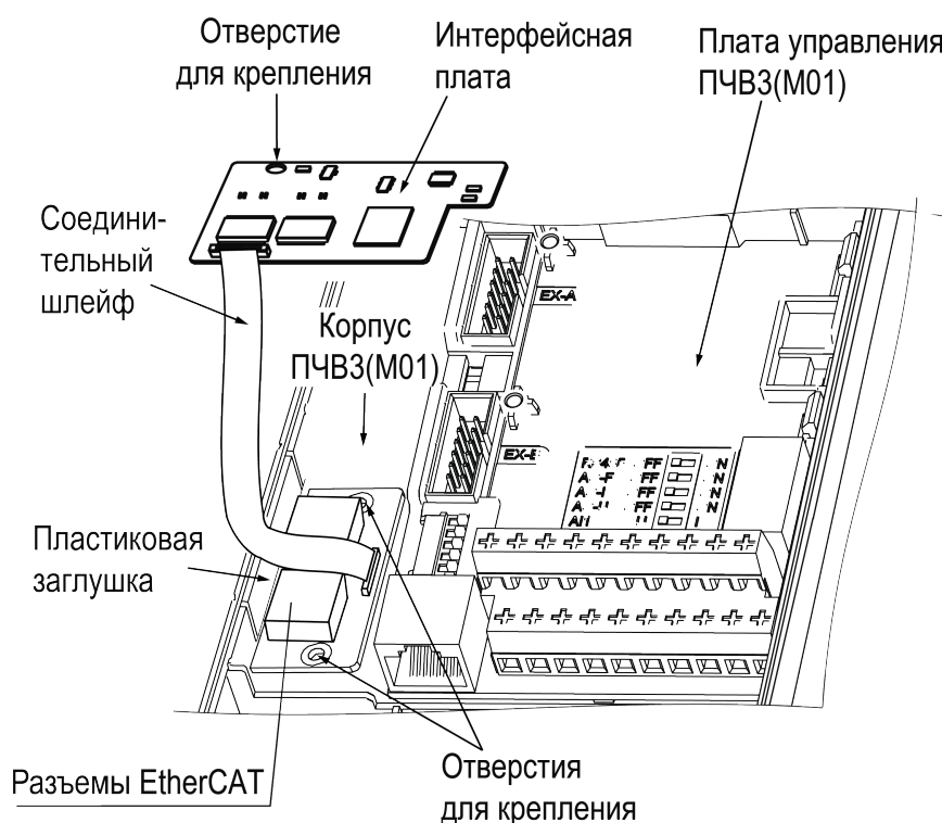
Рисунок 7.24 – Монтаж платы на преобразователях частоты мощностью 5,5 – 45 кВт
