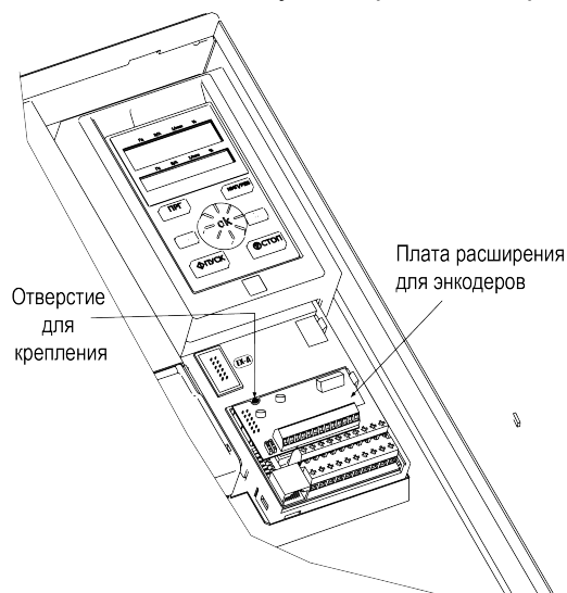
Рисунок 7.31 – Монтаж платы расширения для энкодеров
