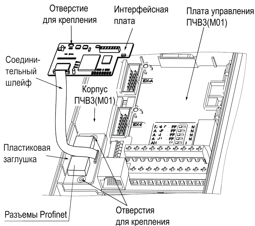
Рисунок 2.2 – Монтаж платы на преобразователях частоты мощностью 5,5 – 45 кВт
