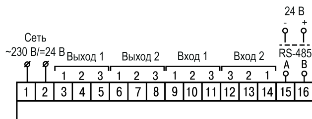
Рисунок 5.7 – Общая схема подключения 2TRM1–Н
