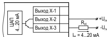
Рисунок 5.26 – Подключение к ВУ типа «И»
