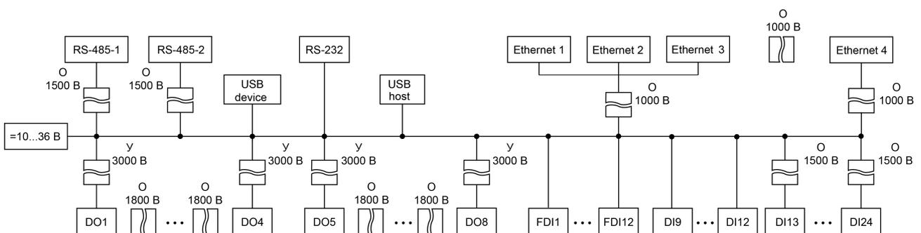
**Рисунок 2.2 – Схема электрической прочности изоляции ПЛК210-12**
