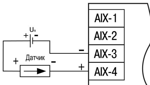
Рисунок 5.15 – Схема подключения датчиков с унифицированным выходным сигналом тока  $4...20$  мА по двухпроводной схеме
