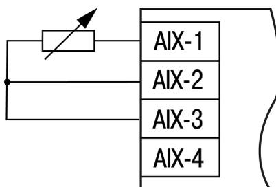
Рисунок 5.17 – Схема подключения датчиков типа 0...2 кОм и 0...5 кОм
