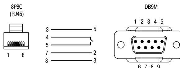
**Рисунок 5.26 – Схема кабеля KC17**
