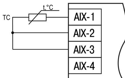
**Рисунок 5.12 – Схема подключения ТС по трехпроводной схеме**
