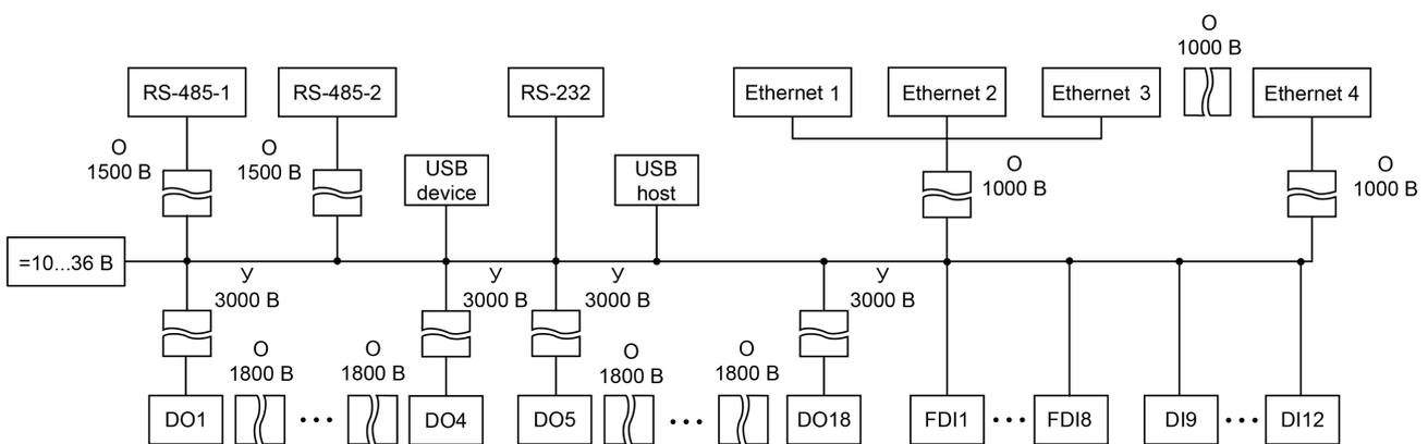
**Рисунок 2.1 – Схема электрической прочности изоляции ПЛК210-11**
