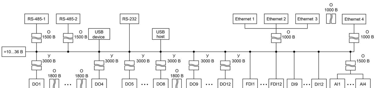
**Рисунок 2.3 – Схема электрической прочности изоляции ПЛК210-14**
