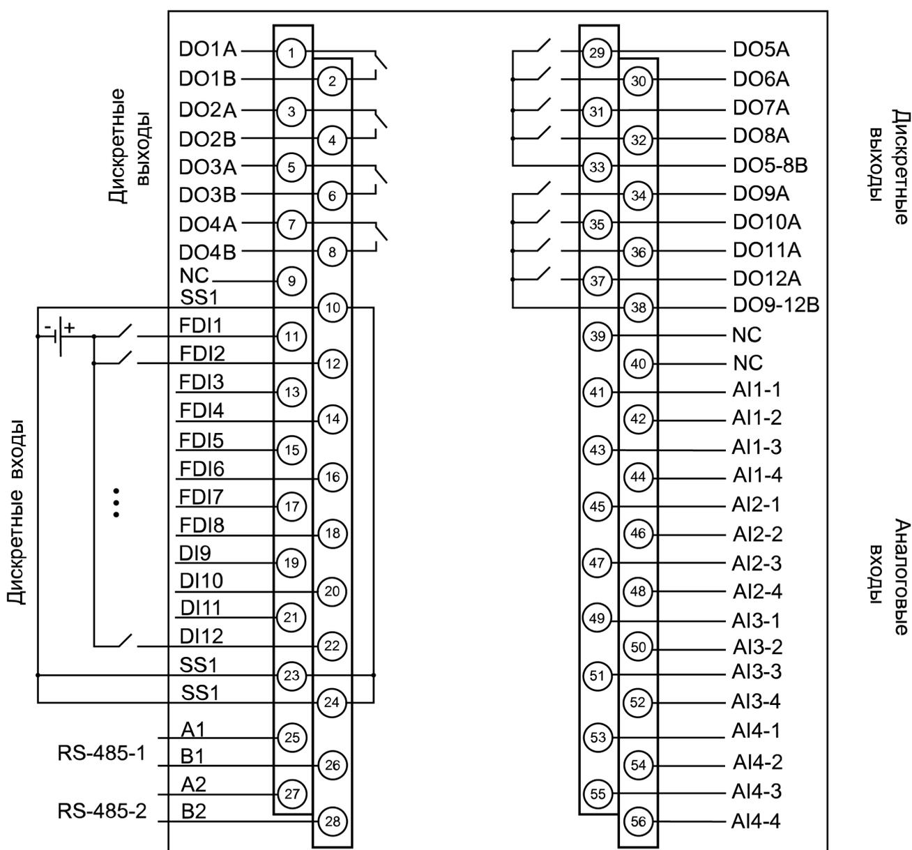
Рисунок 5.4 – Назначение контактов клеммника (модификация 14)
