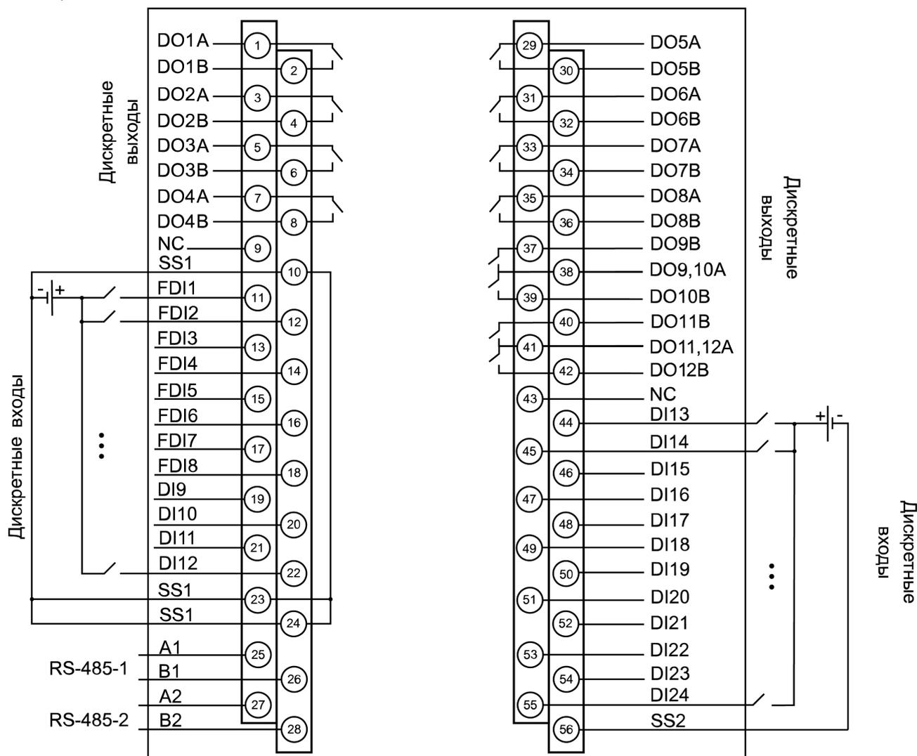
**Рисунок 5.3 – Назначение контактов клеммника (модификация 12)****Таблица 5.2 – Назначение контактов клеммника (модификация 12)**
