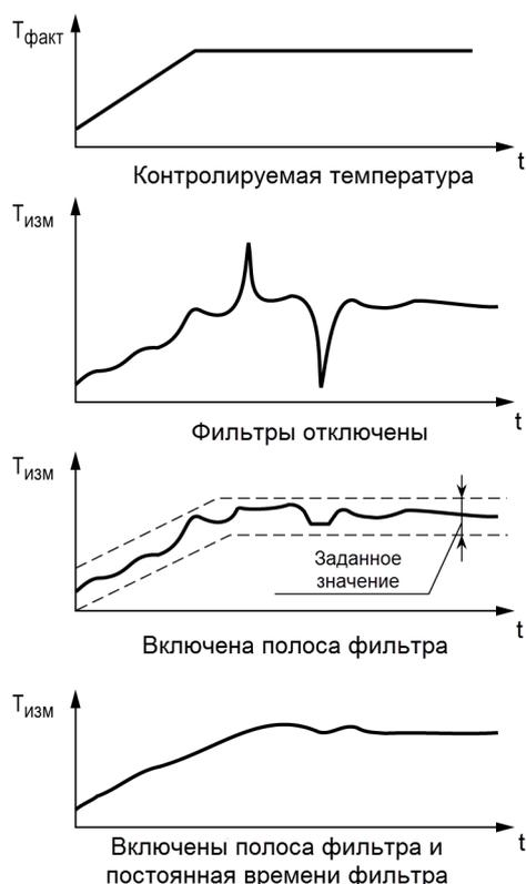
**Рисунок 5.19 – Временные диаграммы работы цифровых фильтров**
