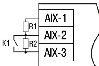
Рисунок 5.18 – Схема подключения датчика типа «сухой контакт»
