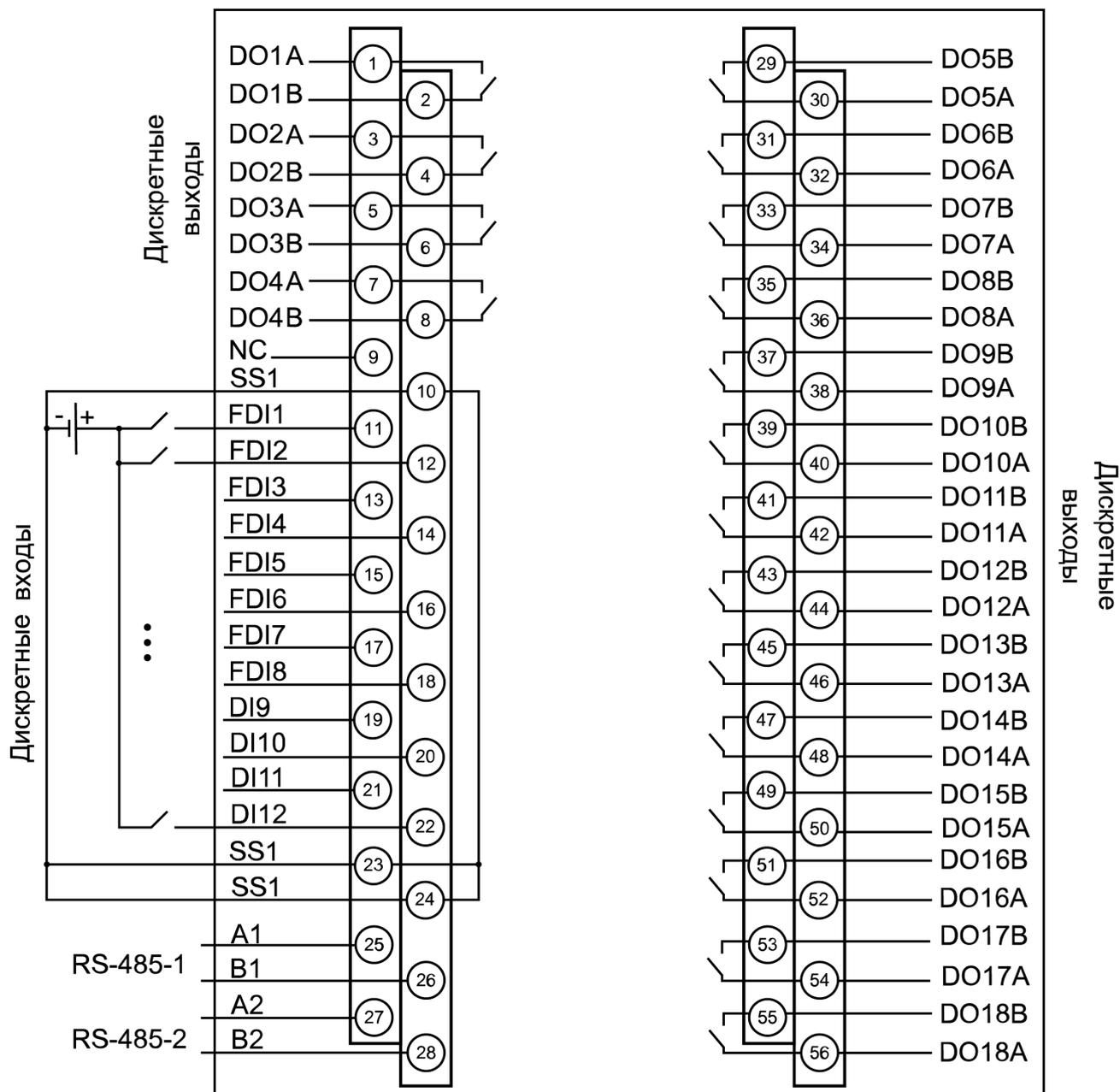
Рисунок 5.2 – Назначение контактов клеммника (модификация 11)
